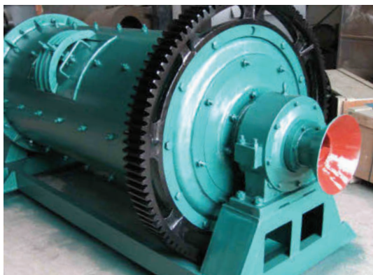
Для измельчения руды используют шаровые мельницы
