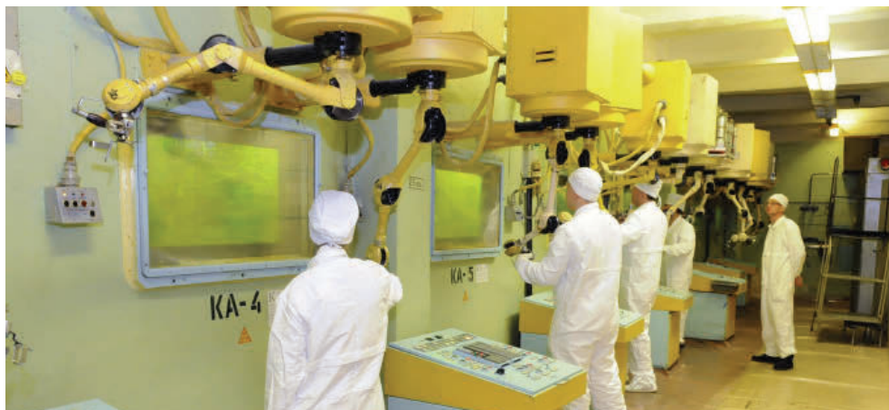
Работа с ОЯТ ведется только за защитой с помощью манипуляторов
