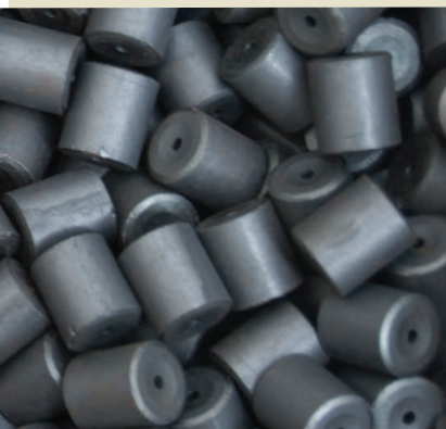
Таблетки ядерного топлива (диоксид урана)
