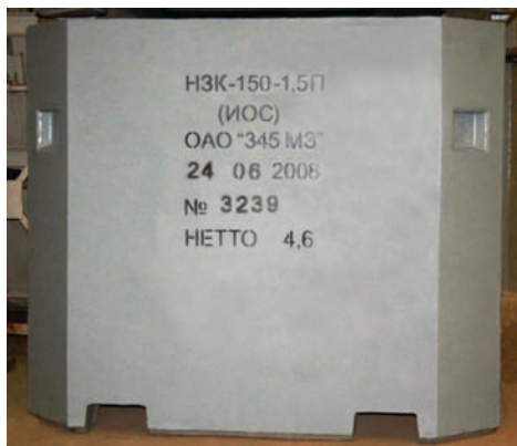
НЗК — контейнер, специально разработанный для хранения РАО
