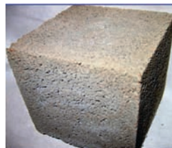
РАО, отвержденные в форме бетонного блока
