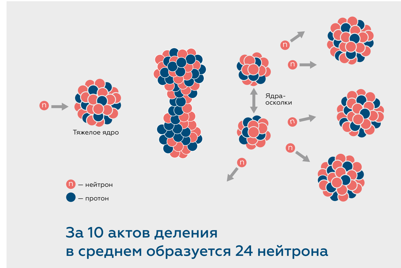
Рисунок 2.3. Схема цепной реакции деления урана-235 нейтронами
